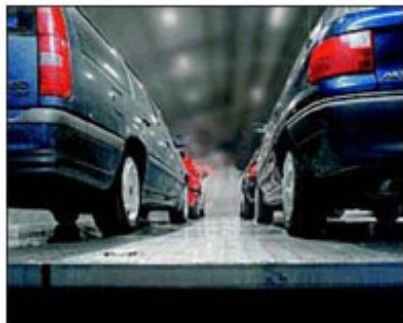
図-4.4 SUS車両甲板パネル採用事例
